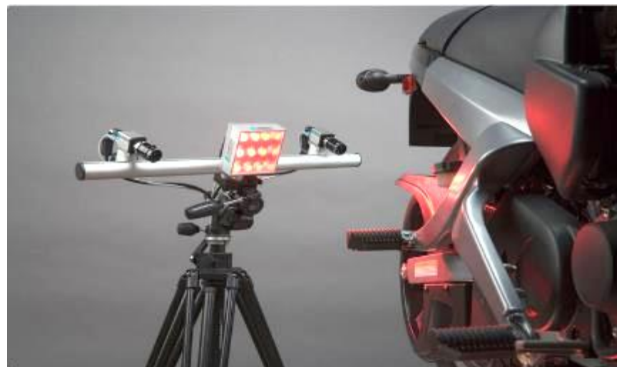
Badania wibracji stuktury motocykla
