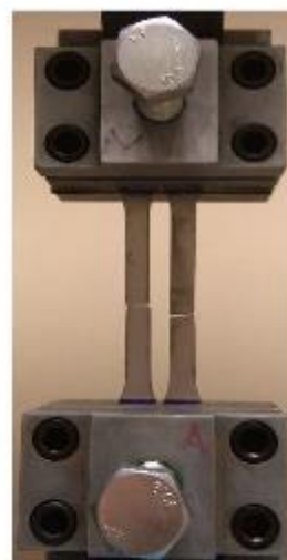
Rezultat rozciągania próbki o oznaczeniu HW03
