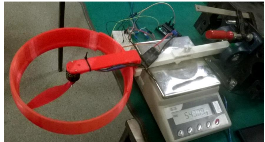
Wyznaczenie charakterystyk ciągu i momentu reakcyjnego
