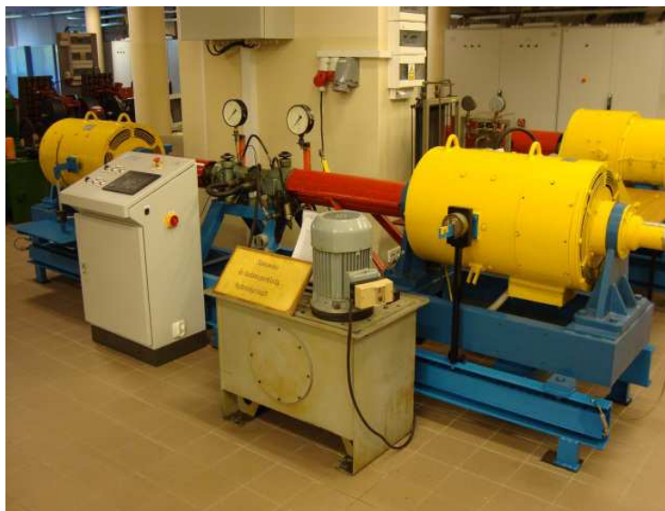
Rysunek 2. Widok ogólny stanowiska badawczego oraz przekładni hydrostatycznej
