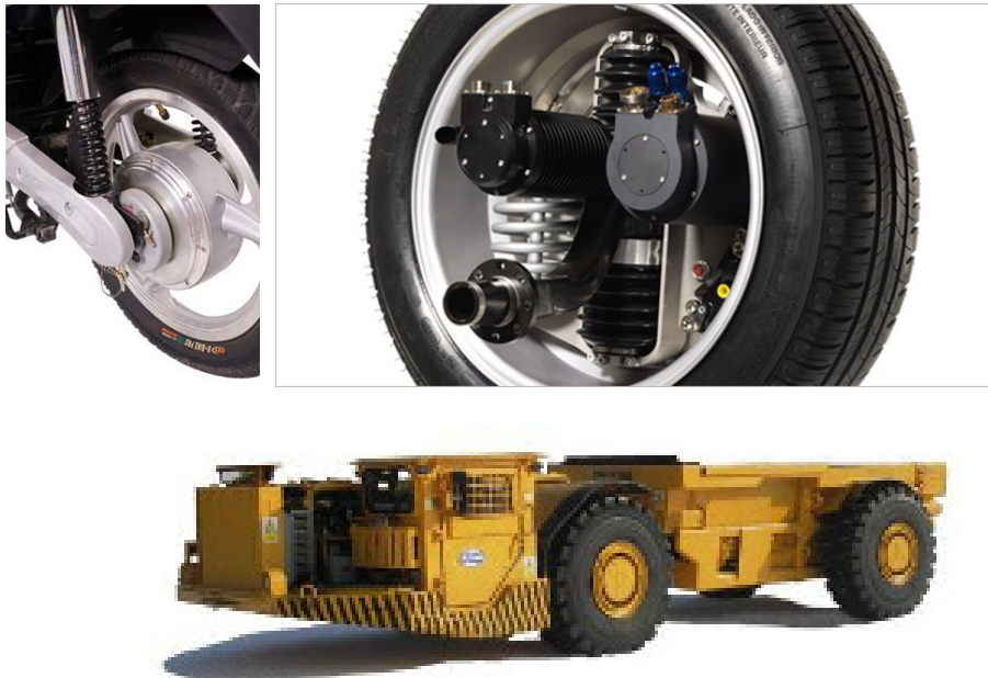
Rys. 7. Przykładowe aplikacje silników wolnoobrotowych zabudowanych w kole: skutera, samochodu, niskopodłogowej maszyny roboczej .
