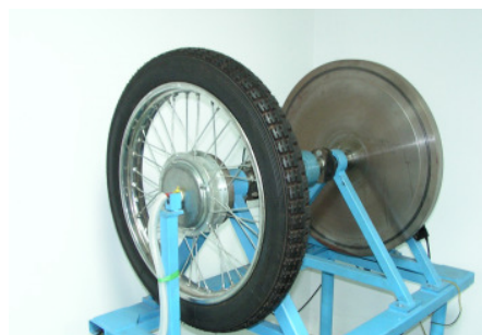
Rys. 9. Koło z silnikiem wbudowanym w piastę, obciążone inercyjnie.
