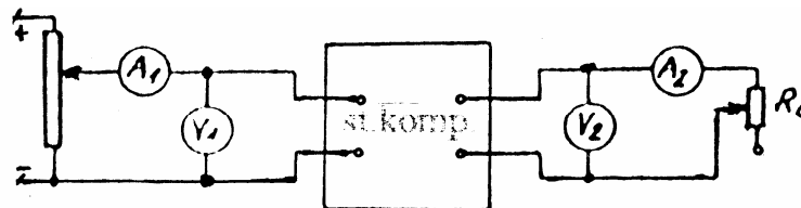
Rys. 4. Stabilizator kompensacyjny – schemat pomiarowy
