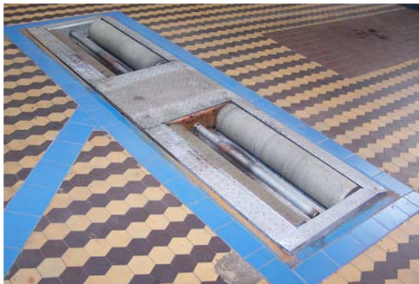
Rys. 2. Rolki stanowiska do pomiaru siły hamowania
