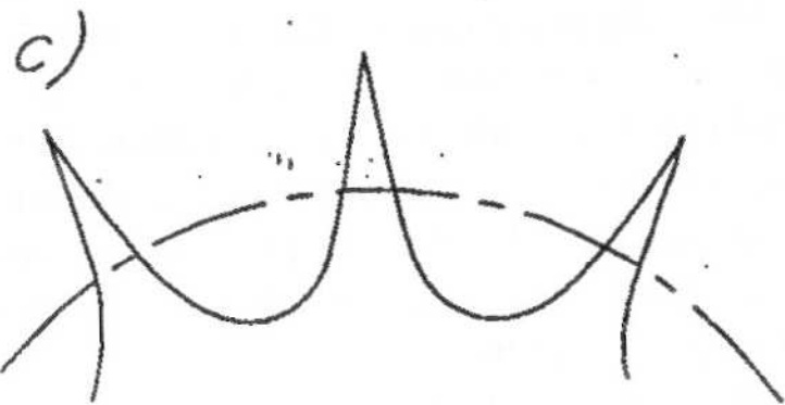
Rys. 2.7. Trajektorie punktów warstwy obojętnej korpusu koła podatnego: a) koła toczone i trajektorie, 1 - okrąg toczny o średnicy d_1 koła podatnego przed odkształceniem, 2 - okrąg toczny koła podatnego po odkształceniu, 3 - trajektoria punktu B' warstwy obojętnej koła podatnego nie obracającego się, 4 - okrąg toczny koła sztywnego; b) trajektoria punktu A warstwy obojętnej koła podatnego, c) trajektoria punktu warstwy obojętnej koła podatnego obracającego się
