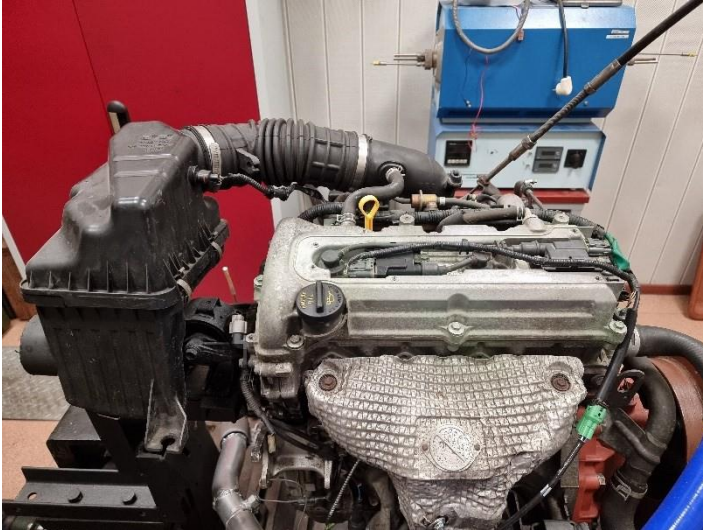
Silnik ZI Suzuki 1.6 przystosowany do indykowania i zmian parametrów regulacyjnych
