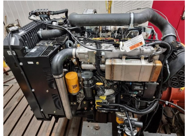
Silnik ZS JCB 444 TA4i-81 I1 zasilany olejem napędowym, CNG, biogazem (silnik od 2021 r. na hamowni)
