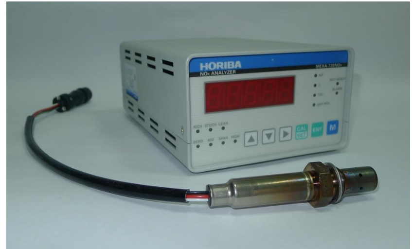
Mobilny analizator do pomiaru stężenia \text{NO}_x i \text{O}_2
