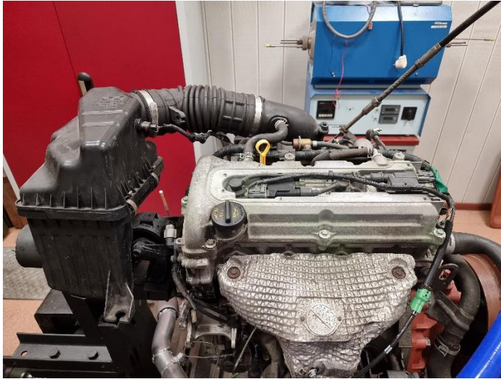
Silnik o ZI Suzuki 1.6 przystosowany do indykowania i zmian parametrów regulacyjnych
