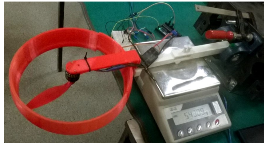
Wyznaczenie charakterystyk ciągu i momentu reakcyjnego
