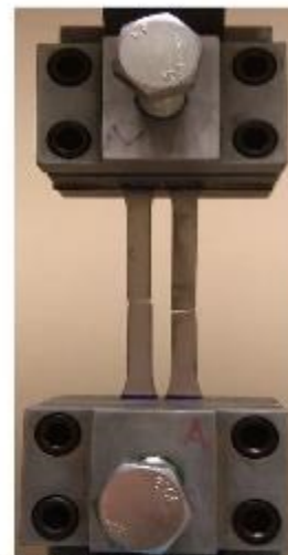
Rezultat rozciągania próbki o oznaczeniu HW03
