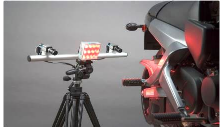
Badania wibracji stuktury motocykla
