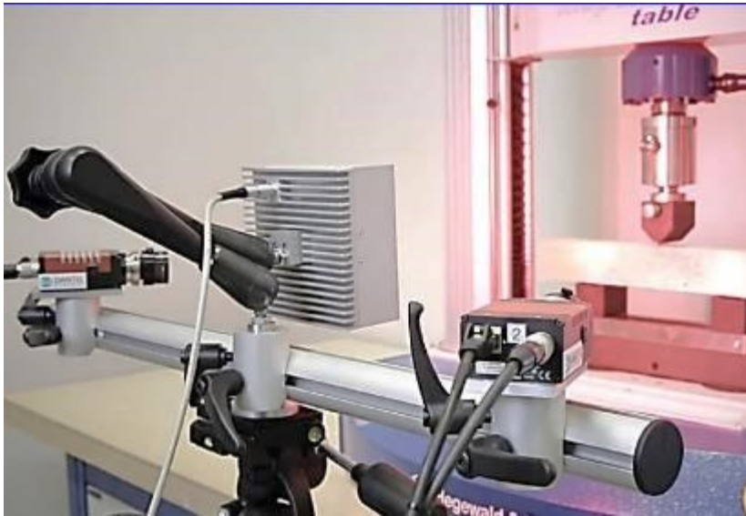
Zobrazowanie rzeczywistych odkształceń
