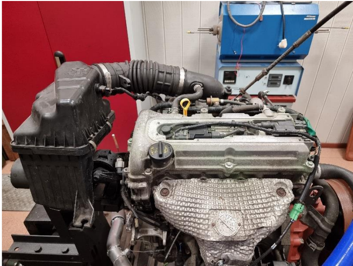
Silnik o ZI Suzuki 1.6 przystosowany do indykowania i zmian parametrów regulacyjnych (silnik od 2021 r. na hamowni)
